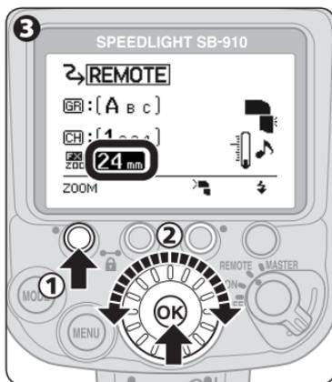
3 Premere il pulsante funzione 1 per selezionare la posizione della parabola zoom, selezionare una posizione della parabola zoom con la ghiera di selezione, quindi premere il pulsante [OK].
