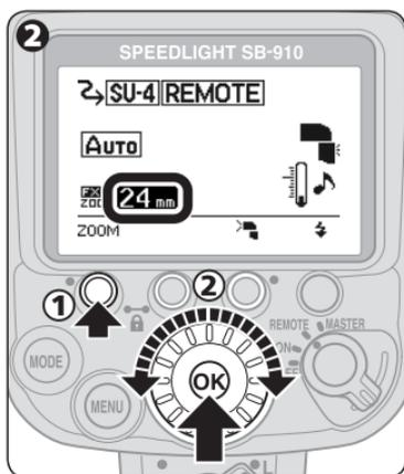
**2** Premere il pulsante funzione 1 per selezionare la posizione della parabola zoom, selezionare una posizione della parabola zoom con la ghiera di selezione, quindi premere il pulsante [OK].
